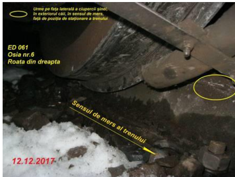
Foto nr.6 - Urme de deraiere în sensul de mers pe cca. 8,00 m de la locomotivă
