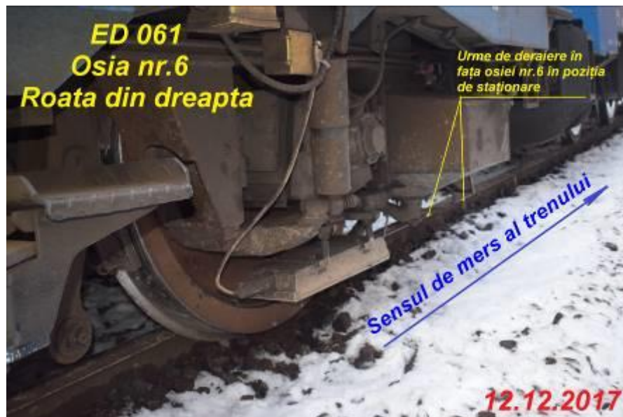
Foto nr.4 - Roata din dreapta osiei nr.6 în poziție deraiată în exteriorul căii. Urme de deraiere în sensul de mers al trenului față de poziția de staționare
