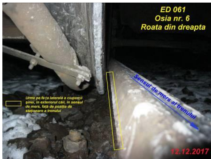
Foto nr. 5 - Urme de deraiere în sensul de mers pe cca. 8,00 m de la locomotivă, față de poziția de staționare a trenului
