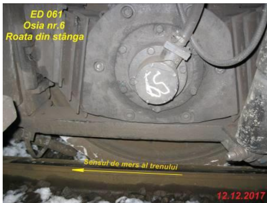
Foto nr.7 - Roata din stânga osiei nr.6 în poziție deraiată în interiorul căii
